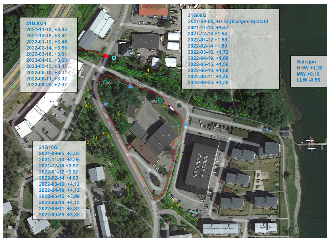
Figur 8. Uppmätta grundvattentrycknivåer samt bedömning av grundvattnets strömningsriktning. Angivna grundvattentrycknivåer är uppmätta från augusti 2021 – september 2022. Grundvattennivån ska förutsättas variera med årstid och nederbörd.
